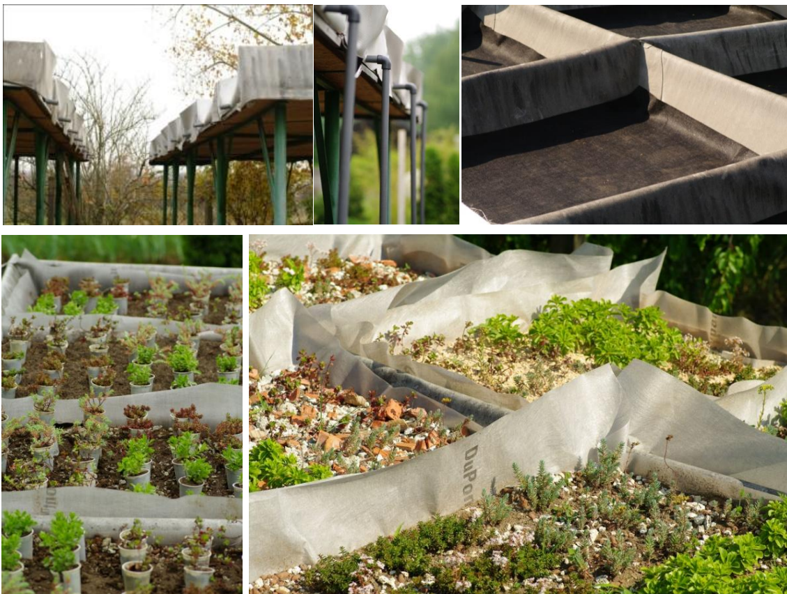
1. ábra. A két kísérleti tető (a) Kísérleti parcellák vízvezető csövekkel (b) Kísérleti tető PVC-vel szigetelt parcellái (c) Parcellák beültetés előtt (d) Parcellák beültetés után (e) (Nyíregyháza, Ilona tanya)
