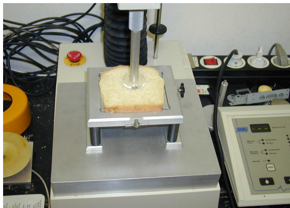
17. ábra: Mérési elrendezés precíziós penetrométernél
