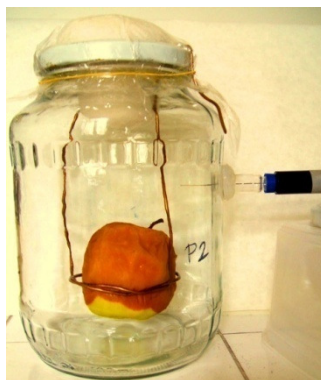
26. ábra: Az illékony vegyületek méréséhez alkalmazott modellkísérleti elrendezés.
