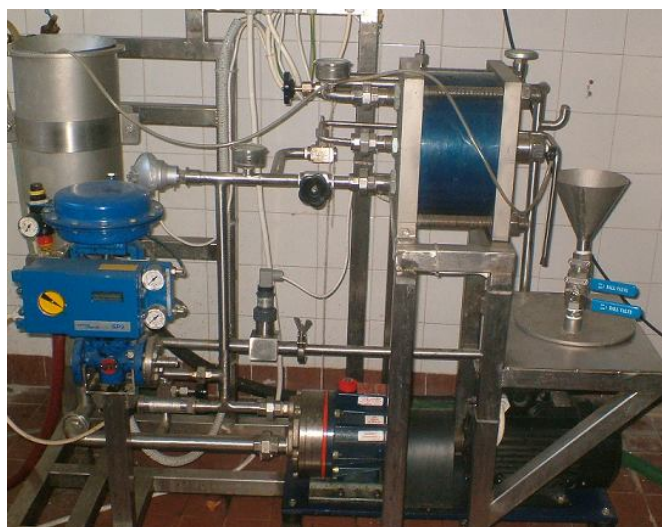
28. ábra: A félüzemi fordított ozmózis berendezés felépítése
