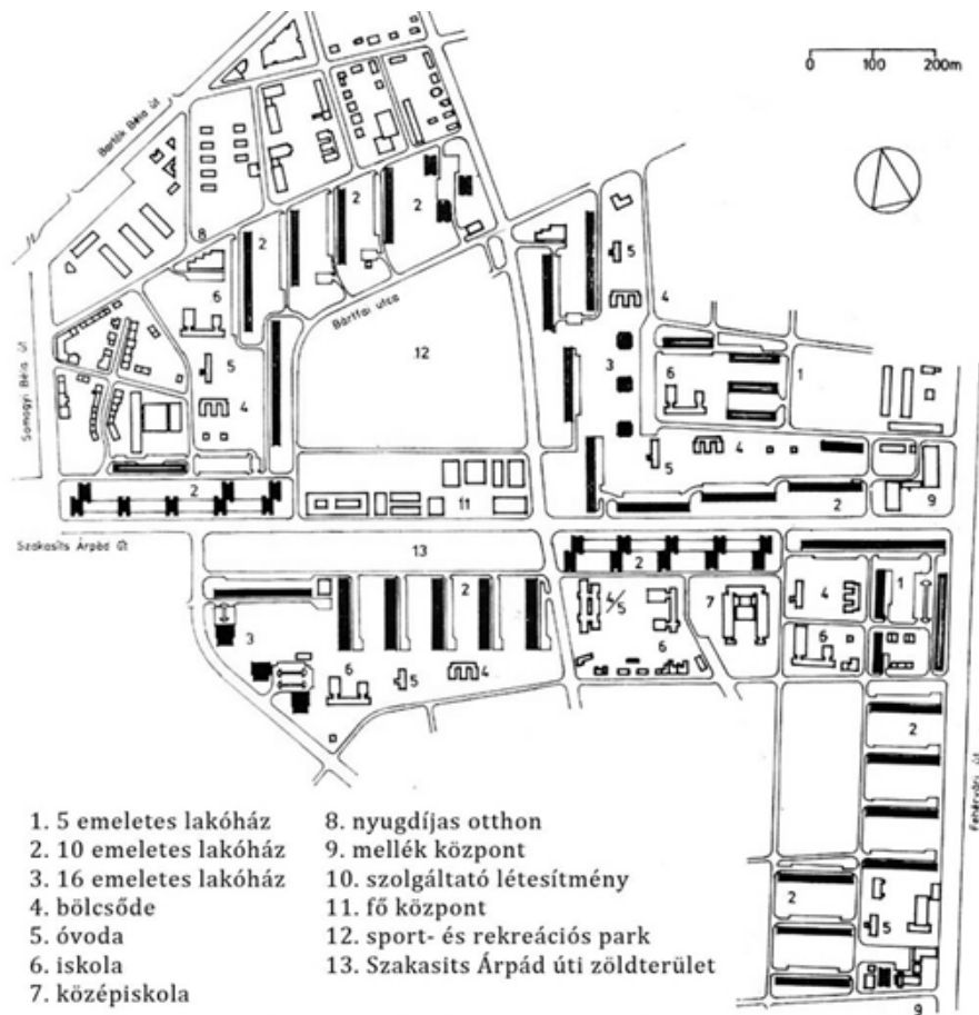
83. ábra - Kelenföldi lakótelep, beépítési terv, 1969, Kiss A. - Kovács B.
