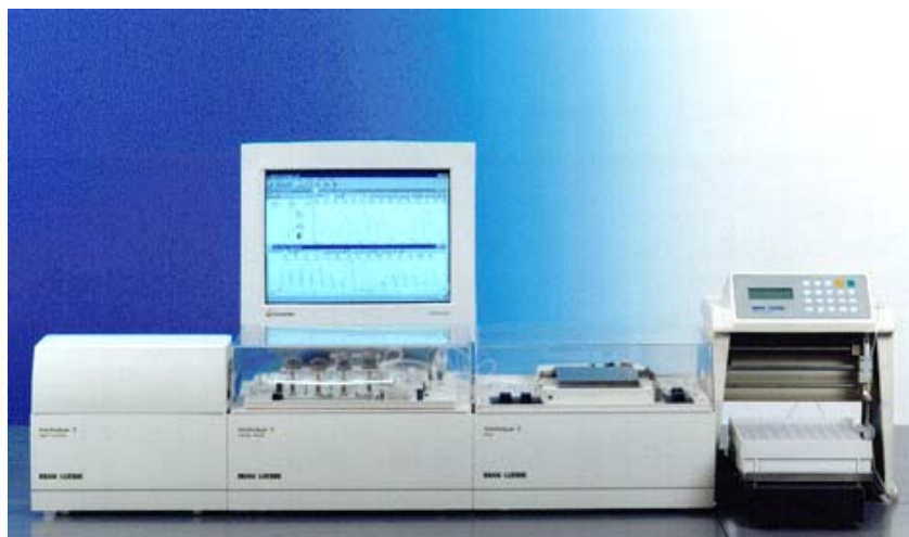
4. ábra Bran & Luebbe gyártmányú AA 3 típusú folyamatos autoanalizátor
