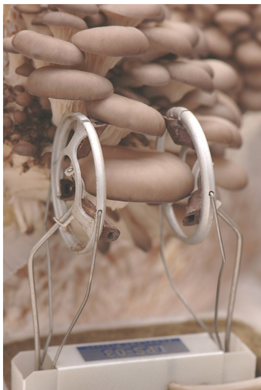
14. ábra: A kalapnövekedés mérése a Phytomonitor műszerrel
