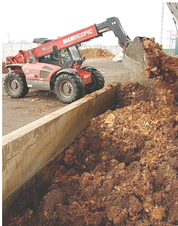
2. ábra: Alapanyag betáplálás (letermett táptalaj) a Pilze-Nagy Kft. biogáz-üzemében
