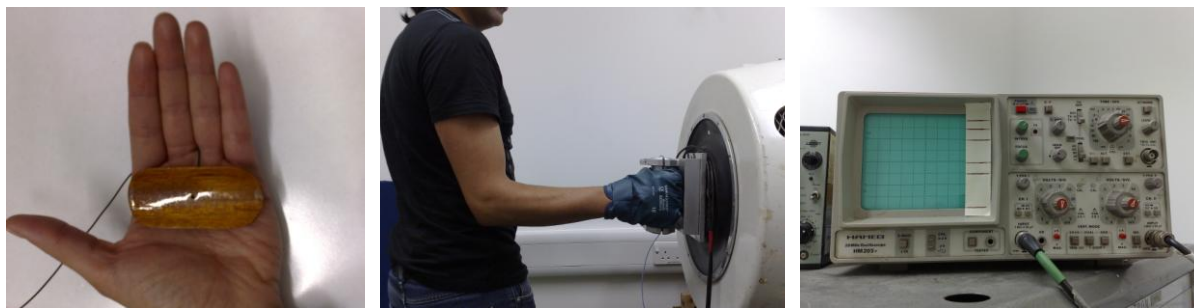
15. ábra Kézi adapter a gyorsulásérzékelővel, a tesztalany pozíciója a mérés során és a kézi erő nagyságát mutató oszcilloszkóp (balról jobbra) (saját fotó).
