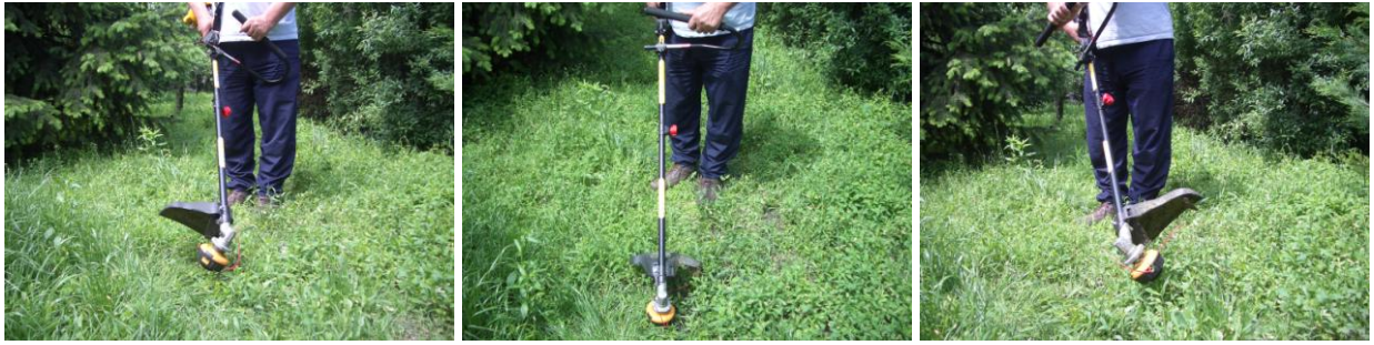
13. ábra Fűkasza kézben tartásának módja az üzemeltetési pozíció rezgésterhelésre gyakorolt hatásának vizsgálatakor (saját fénykép).
