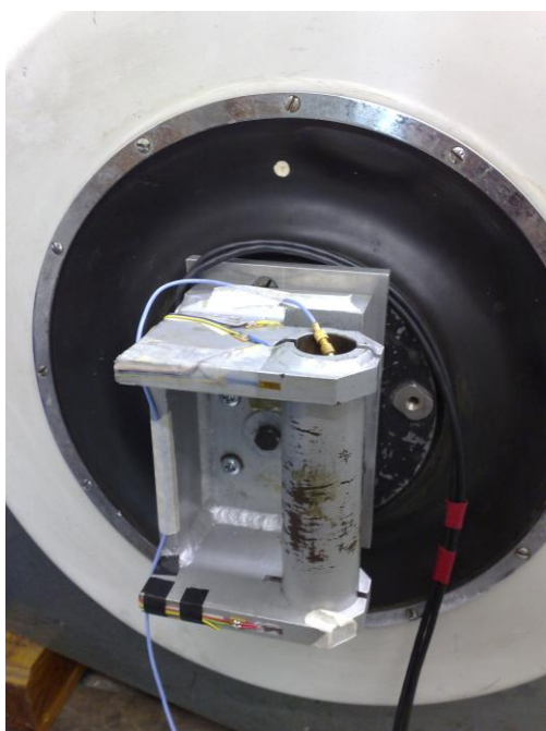
M.2.(a) ábra A fogantyú a nyúlásmérővel és gyorsulásérzékelővel (bal kép) és a fogantyú kalibrálása (jobb kép) (saját felvétel).
