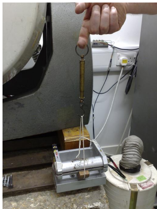
M.2.(a) ábra A fogantyú a nyúlásmérővel és gyorsulásérzékelővel (bal kép) és a fogantyú kalibrálása (jobb kép) (saját felvétel).
