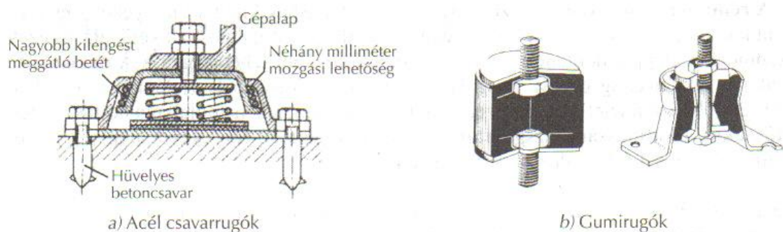
M.1.(d) ábra Rezgésszigetelő gépelemek (acél csavarrugó- bal kép, gumirugó – jobb kép) (Walz 2008).
