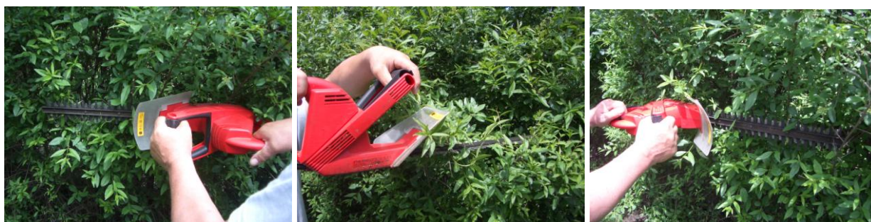
12. ábra Sövényvágó kézen tartásának módja az üzemeltetési pozíció rezgésterhelésre gyakorolt hatásának vizsgálatokor (saját fénykép).
