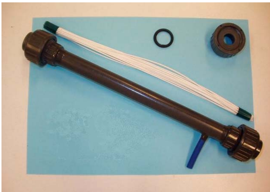
12. ábra Az M5 vagy M6 membrán modul fényképe félkész állapotban
