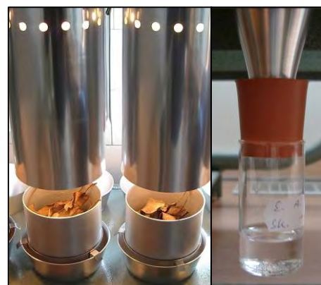
6. ábra. Tölcséres atkafuttató berendezés ölpohárral
