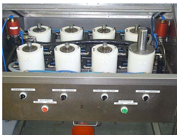
Több edényes nagynyomású készülék, (Resato, Hollandia).
