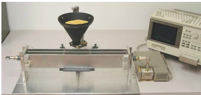
8. ábra: A tesztcella és a mérési összeállítás a USDA-GIPSA-nál
