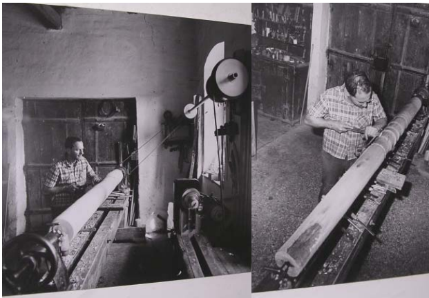
312. Id. Pausch Antal pajtában felállított esztergályát fiatal korában még emberi erő hajtotta, ugyanazt az esztergát Pausch úr időskorára már elektromosság működteti
