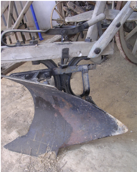
360. A fordítóeke a dombvidéki szántáshoz nélkülözhetetlen. Az ekevasat a parcella végén át lehet fordítani, így az ekével megfordulva visszafelé azonnal lehetett szántani és a következő barázdát az előzővel azonos irányba lehetett dobni.
