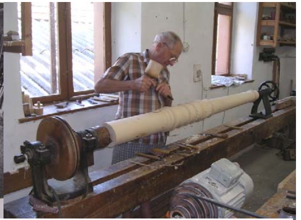
312. Id. Pausch Antal pajtában felállított esztergályát fiatal korában még emberi erő hajtotta, ugyanazt az esztergát Pausch úr időskorára már elektromosság működteti
