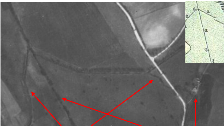
290. A völgyekben kialakított vízrendszer elemei voltak a malmok (pl. Schrecksmühl), a hozzájuk vezető malomárkok, és az eredeti völgyfenéki vízfolyás (pl. Rák-patak). A rendszer elemei az 1953-as légifotón még tökéletesen láthatók.
