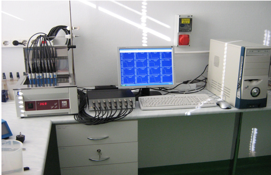
1. ábra. 16 csatornás mérőműszer teljes kiépítéssel.
