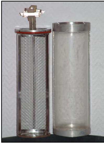
2. ábra. A szétszerelt állapotú reaktor modul, illetve a fejrész a csőcsatlakozókkal
