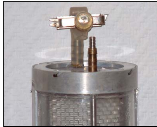
2. ábra. A szétszerelt állapotú reaktor modul, illetve a fejrész a csőcsatlakozókkal
