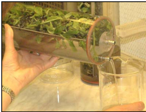
4. ábra. A tápfolyadék leengedése a modulból, majd a zárófedél kinyitása
