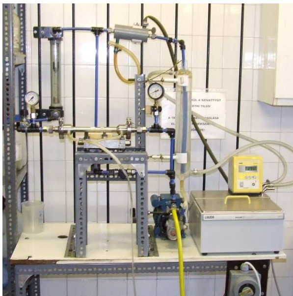
13. ábra: A laboratóriumi membrános nyálkátlanító.
