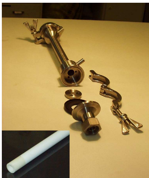
16. ábra: A kerámia csőmembrán és szerelvényei.
