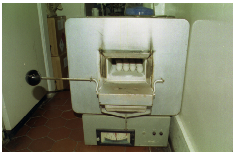
47. ábra: Izzítókemence a Gyógy-és Aromanövények Tanszék laboratóriumában porcelán tégelyekkel (Fotó: Kozak, 2006)
